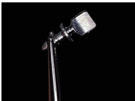
Рис. 1. Дизайн мини-винта для остеосинтеза из магниевого сплава (Mg-Zn-Ga).
